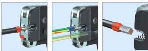
应用在配电箱时，套管式端子从前端送入 在较小的空间时，套管式端子也可以从侧面送入 方形压线确保导线与连接头保持最合适的接触
